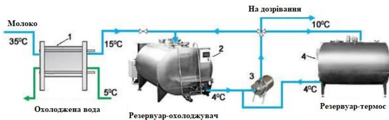
Рисунок 1.9 – Комбінована схема охолодження молока в резервуарі охолоджувача з попереднім теплообмінником
