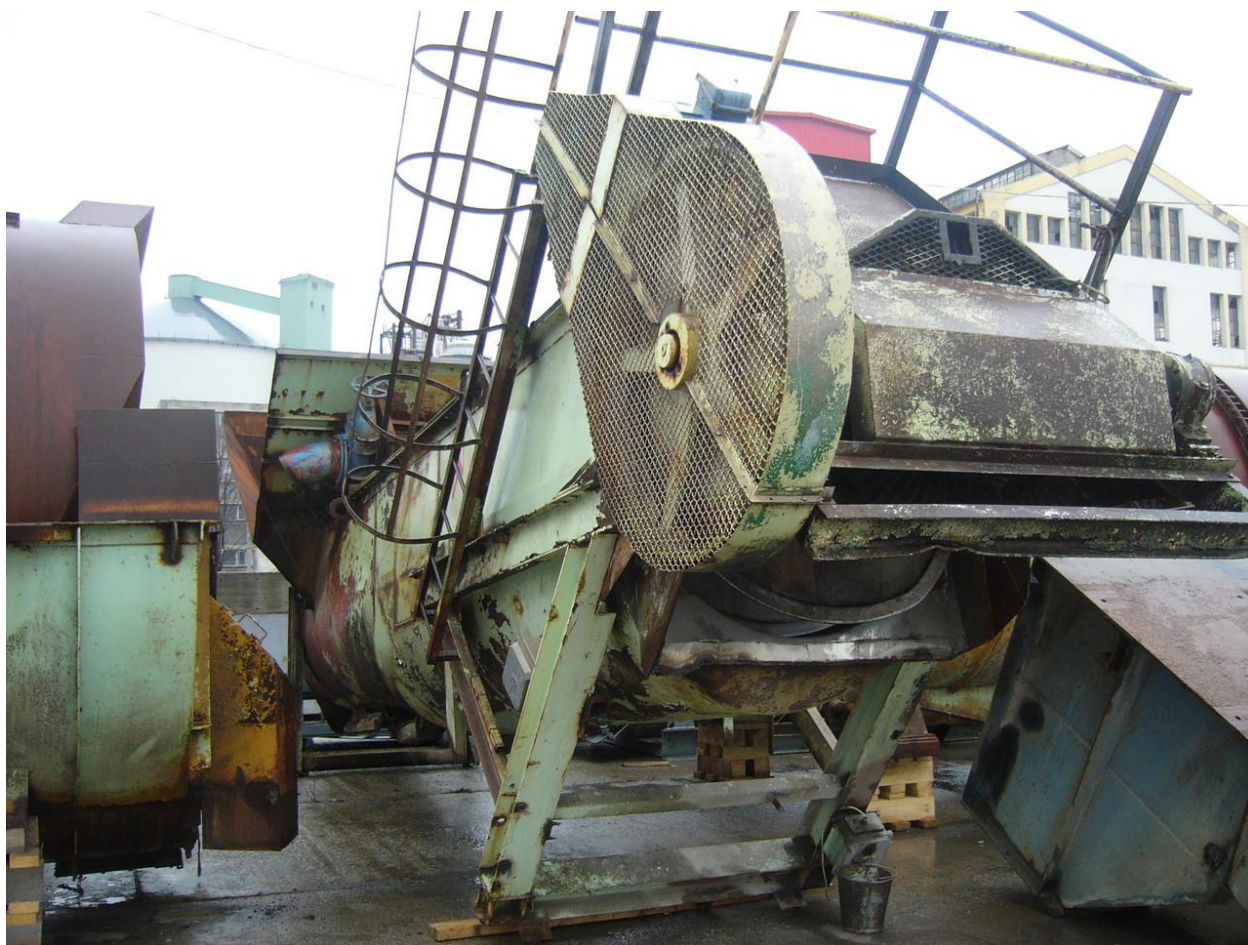
Рисунок Б.1 Кутовий шнек подачі буряків (з водороздільником), 6000 т/добу. Матеріал виготовлення вала і стінок шнека - нержавіюча сталь. Габарити шнека: 1600*8000*1700мм. Діаметр вала – 1500мм. Маса – 11500 кг
