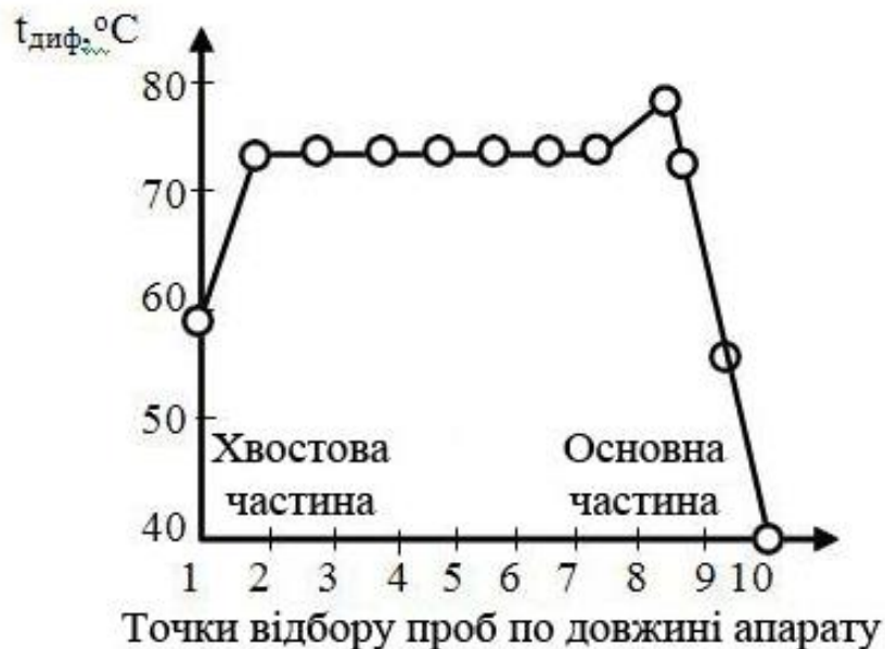
Рисунок 1.6 - Приблизний температурний режим в похилому ДА
