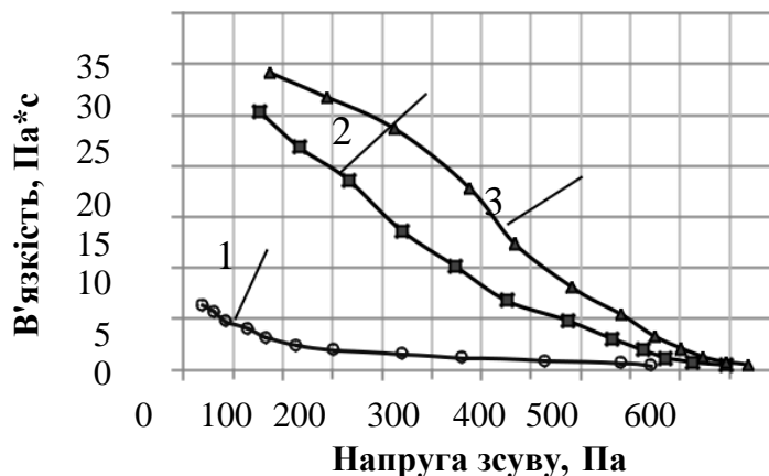
Рис. 1. Криві ефективної в'язкості модельних систем тіста з крохмалю після замішування: 1 – з камеддю гуару; 2 – з камеддю ксантану; 3 – з сумішшю камедей.
