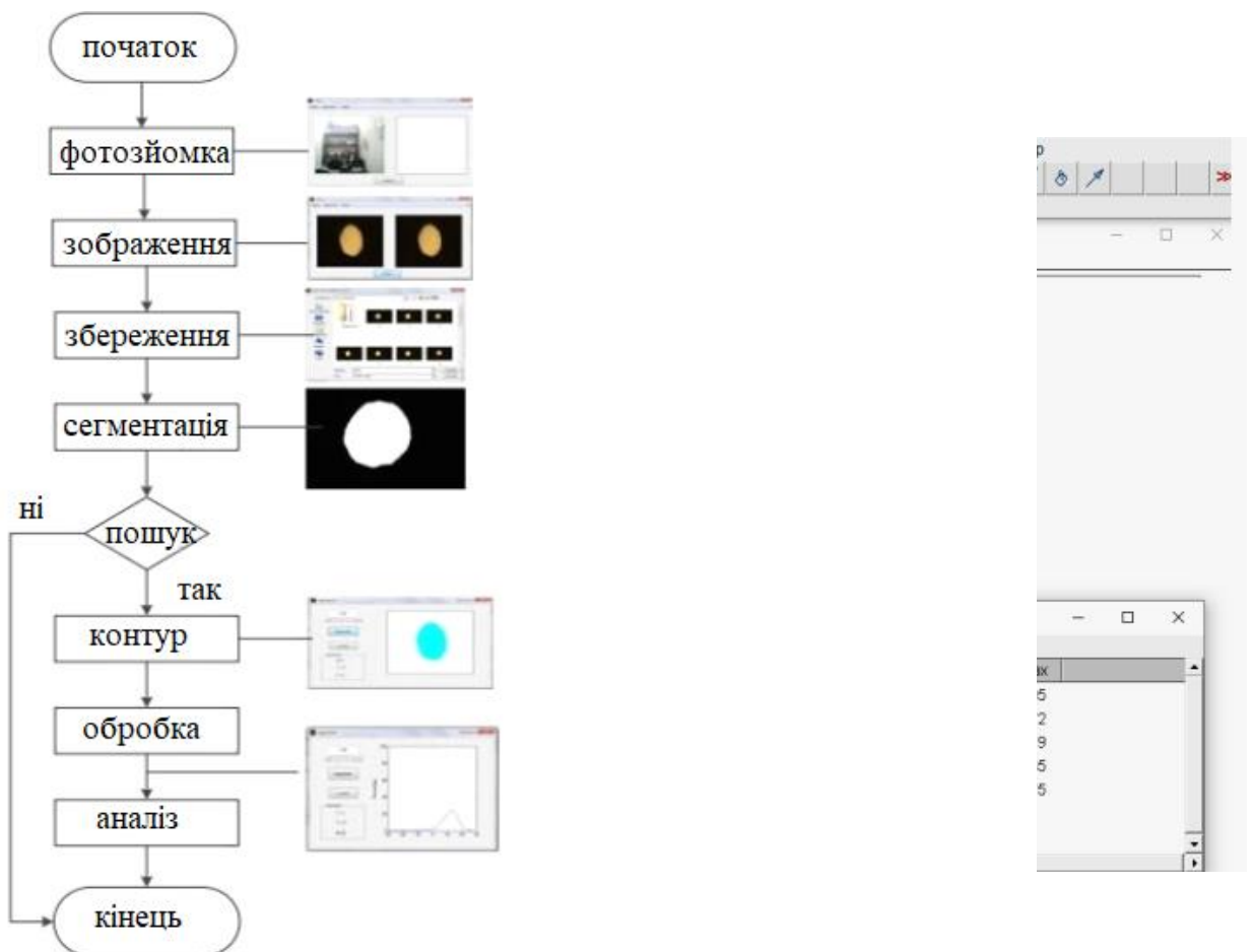
Рисунок 3.2 – Аналіз колірних характеристик картоплі фри за допомогою програми ImageJ
