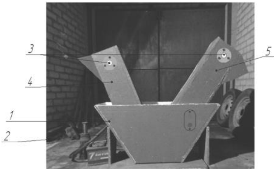
Рисунок 2.3 – Установка для обсмажування скибочок яблук та картоплі
