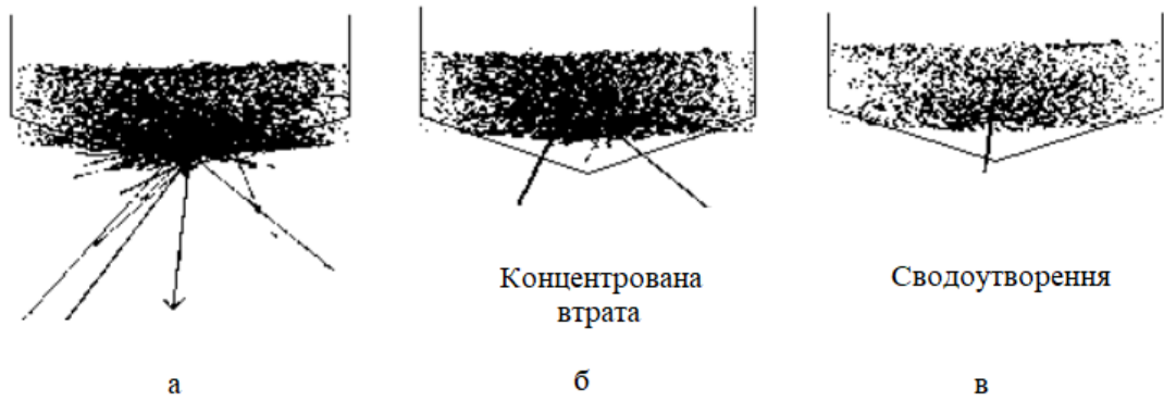
Рисунок 2.9 – Процес утворення порожнечі біля вихідного отвору при руху з бункера дрібних частинок МК (кут нахилу бункера 15^\circ , діаметр отвору витікання = 30 мм)
