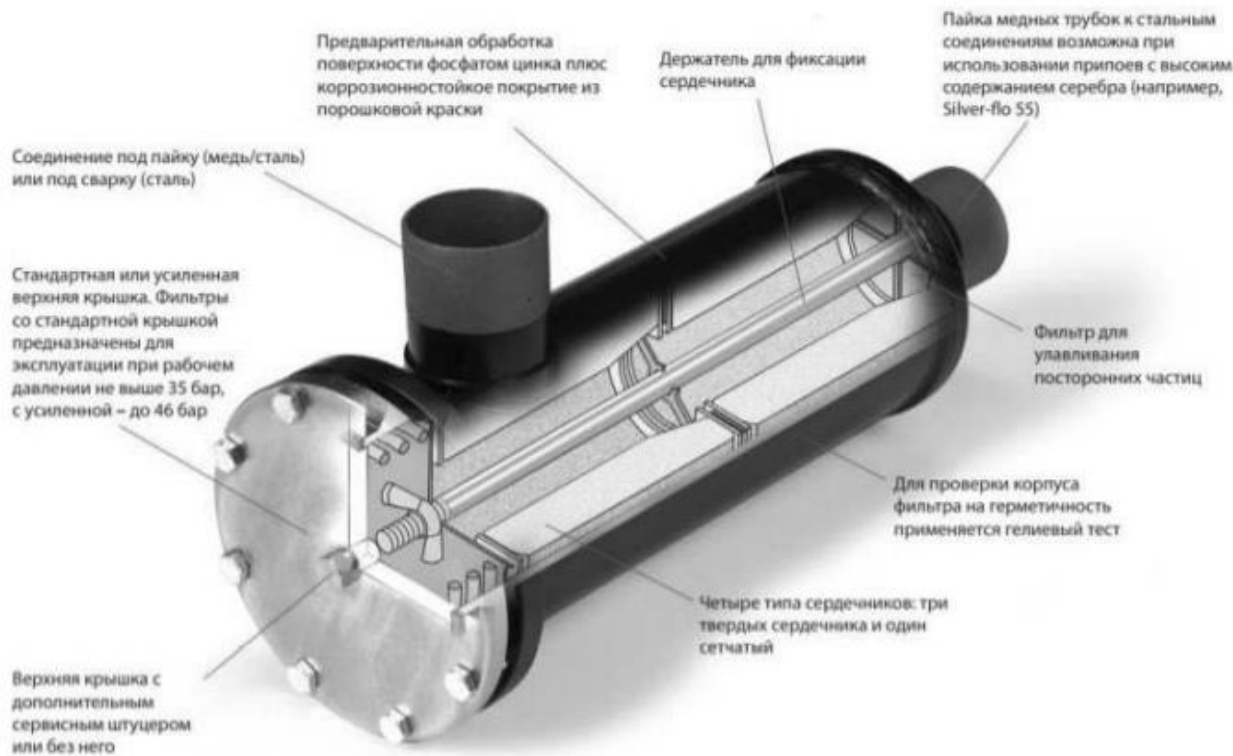
Рисунок 2.6 – Конструкция фильтра-осушувача
