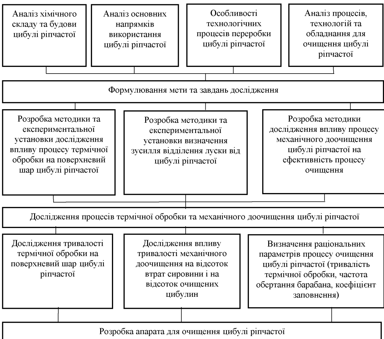
Рисунок 1.12 – Загальний план проведення теоретичних та експериментальних досліджень
