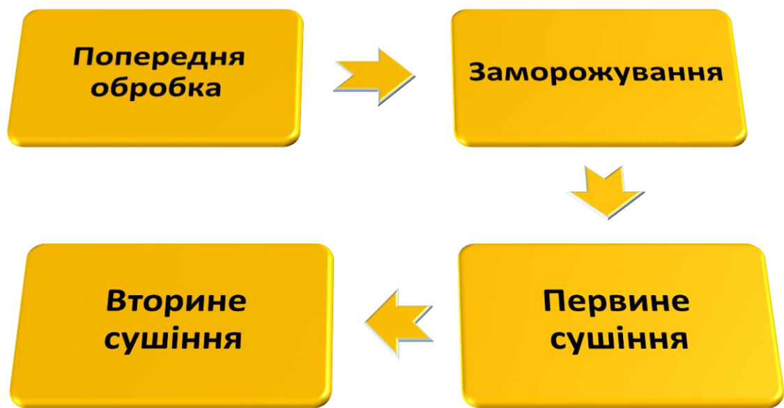
Рисунок. 1.2 – Етапи ліофілізації харчових продуктів
