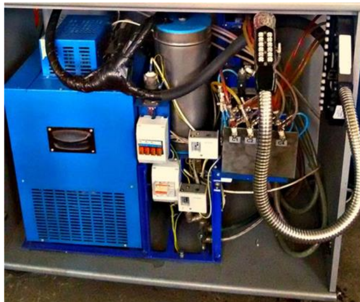
Рисунок 2.4 – Автомат АВ-4 з сатураційно-водоохолоджувальним агрегатом (СВА)
