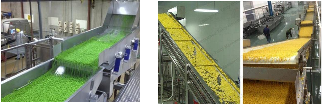
Рисунок 1.6 – Лінії переробки кукурудзи та зеленого горошку
