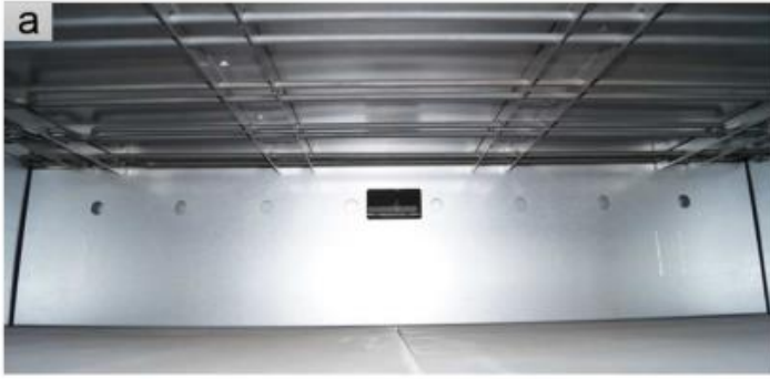
Рисунок 2.7 – Вид спереду в пекарській камері електродуховки з верхнім нагрівачем, встановленим на стелі (а) і нижній нагрівач, розміщений під пластинами для випічки (б)
