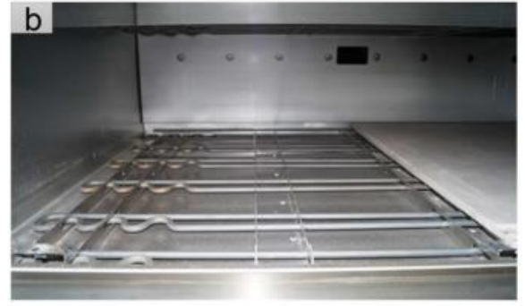
Рисунок 2.7 – Вид спереду в пекарській камері електродуховки з верхнім нагрівачем, встановленим на стелі (а) і нижній нагрівач, розміщений під пластинами для випічки (б)
