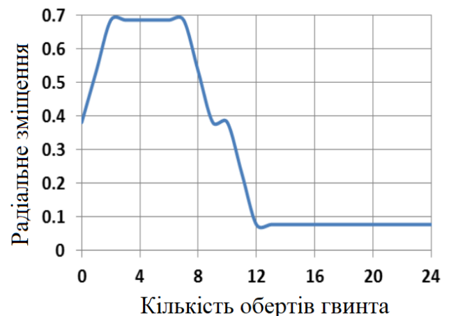
Рисунок 3.4 – Екструзійне навантаження на шнек екструдера з кроком нарізки витків, що зменшуються при 185°
