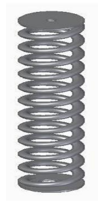
Рисунок 2.2 – Пружина, яка забезпечить належну вібрацію сита
