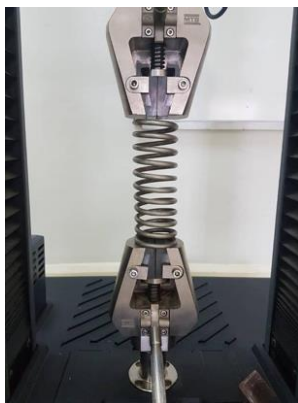
Рисунок 2.1 – Пружина під час випробувань
