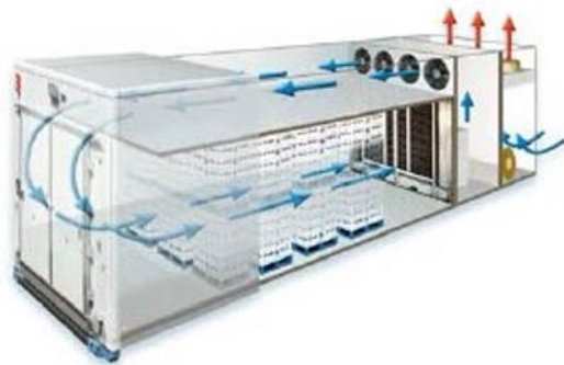
Рисунок 1.1 – Тунелі заморожування зі статичним продуктом
