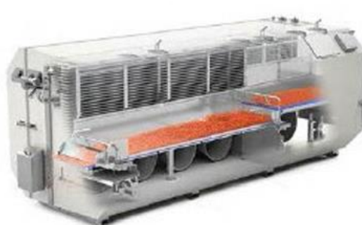
Рисунок 1.2 – Тунелі заморожування з продуктом у русі
