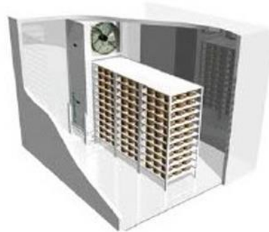
Рисунок 1.1 – Тунелі заморожування зі статичним продуктом
