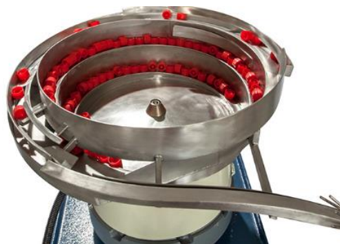
Рисунок 1.7 – Сортування за допомогою обертового барабана
