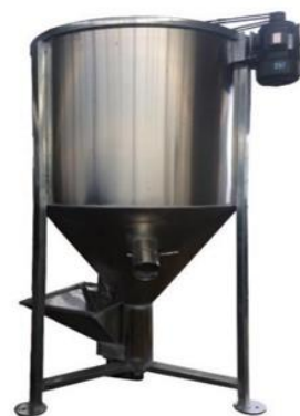
Рисунок 1.2 – Вертикальна змішувальна машина
