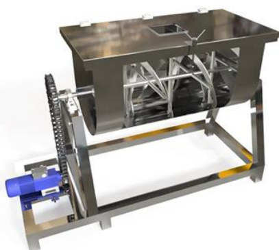
Рисунок 1.1 – Горизонтальний змішувач зі спіралеподібними стрічками
